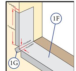
G. **Recorte lengüetas en la cinta tapajuntas para alféizar y dóblelas.** Corte lengüetas de 1 pulgada de ancho en cada esquina (1/2 pulgada a cada lado de la esquina) (1G). Doble la cinta hacia el exterior y presione firmemente para adherirla a la barrera resistente al agua.
